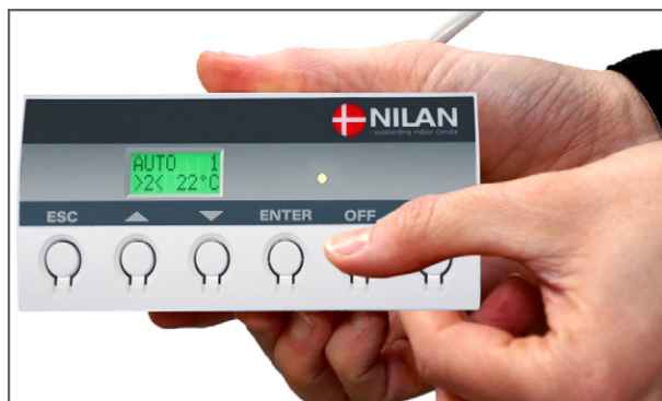
8. Gå i menuen VIS ALARMER på betjeningspanelet og nulstil alarmer her
