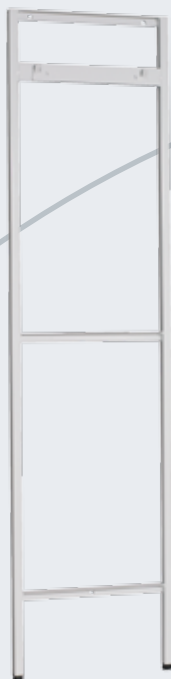
H-stativ Til montering i forbindelse med »svage« og »skæve« vægge. Hviler på gulvet og fastgøres i væggen. Monteret med justerbare ben.
