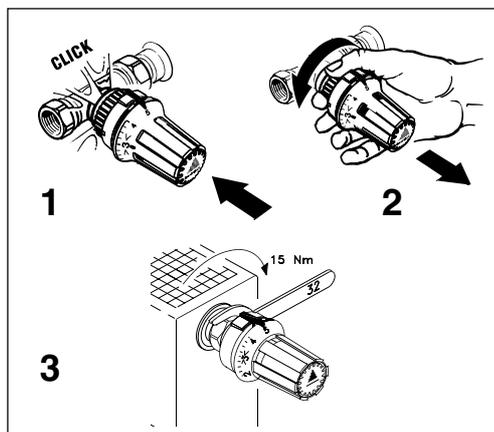
RAS-C elementer med snap-kobling monteres let og uden brug af værktøj efter at ventilens dækhætte er fjernet: Tryk elementet på ventilen. En spændering bevirker, at lukkemekanis-men udløses ved berøring med ventilen. (1)
