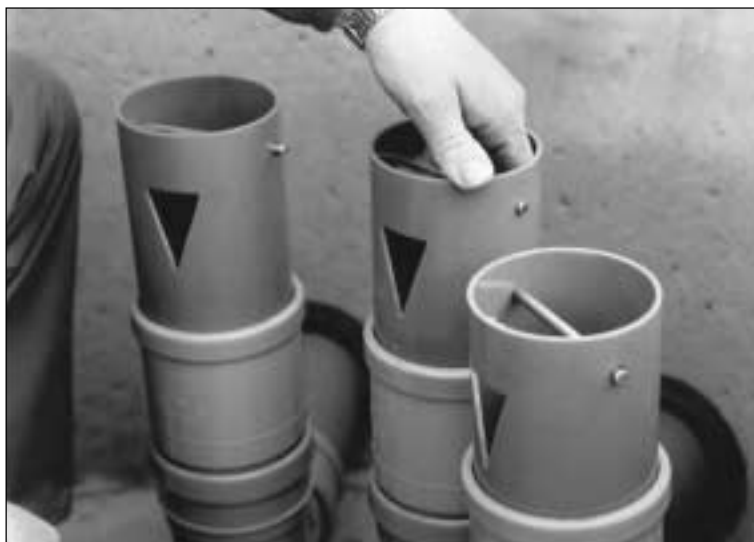
Fig. 12. Fordelerbrønd til store nedsivningsanlæg. Udløbsfordeleren er forsynet med et ekspansionsstykke, så højden kan reguleres præcist.
