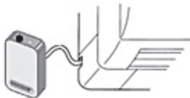
Figura 4.- Posicionamiento del dispositivo IntesisHome® Device y el AA
