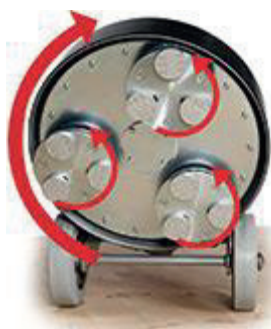
Figur 41 Illustrerer slibehovedernes rotation i forhold til gearhuset.
