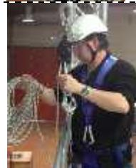
3/ L'utilizzatore dovrà fissare il discensore all'imbracatura del suo collega e bloccare il moschettone.
