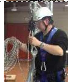
3/ L'utilizzatore dovrà fissare il discensore all'imbracatura e bloccare il moschettone.
