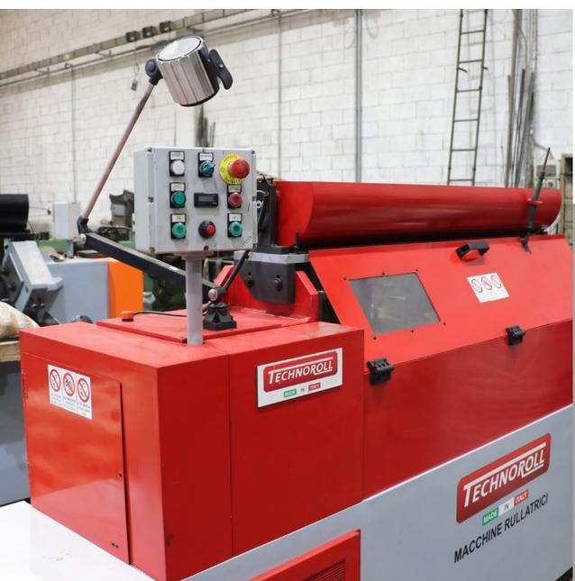
Produzione tiranti filettati parzialmente in automatico destinati a varie tipologie di settori **da M5 a M16**, anche ad alta resistenza **8.8/10.9**.
