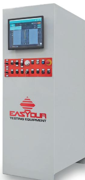
L'obiettivo di Easydur è progettare macchine per prove di trazione ad alto carico in grado di raggiungere le **300 Tonnellate**, mantenendo una precisione eccezionale: ecco perché le macchine Easydur ad alto carico montano **pinze idrauliche ad attuatore doppio**, celle di carico ad alta risoluzione e possono essere equipaggiate con differenti video estensimetri.
