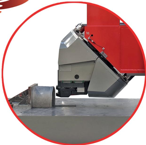
Il controllo della qualità è una delle principali necessità del settore metallurgico e la prova di durezza, generalmente **Brinell 10/3000**, è parte integrante del processo produttivo di prodotti forgiati, laminati e trattati a caldo.
