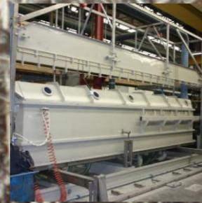
Il classico sistema di decapaggio di tubi e barre in acciaio inox, viene oggi rivoluzionato attraverso una innovativa soluzione impiantistica proposta dal gruppo Condroil che permette lo svolgimento delle varie fasi del processo (decapaggio / passivazione e
