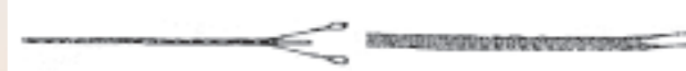
Calza con due redance passante o aperta Cable grip with double eye end pulls
