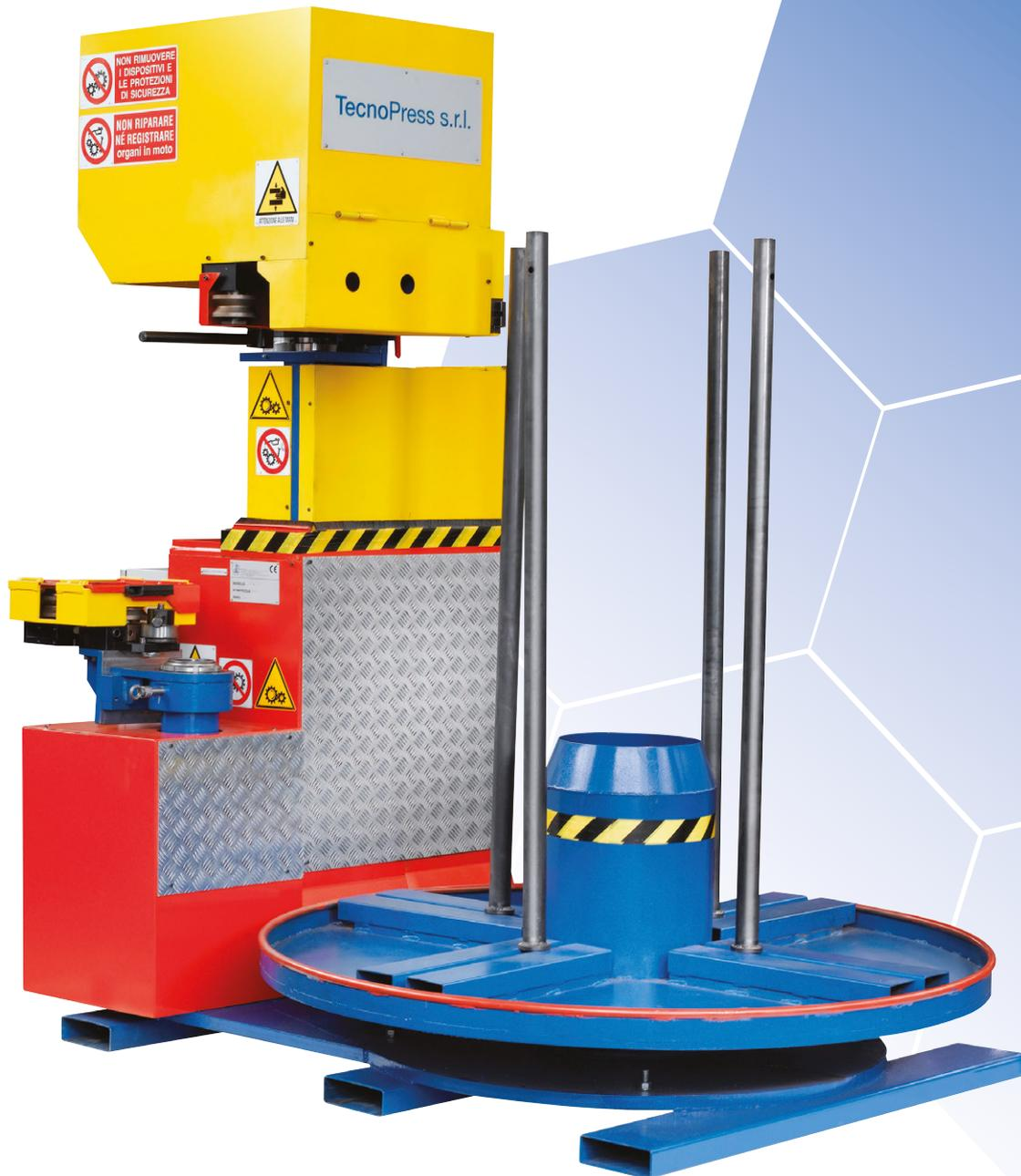
● Lo Svolgitore TP 20 SM è un apparecchio progettato per sostenere matasse di filo e trascinarle all'interno della stampatrice. E' in grado di operare con matasse pesanti fino a 3 tonnellate e con un filo di diametro da 10 mm fino a 22 mm. Le matasse sono alloggiare in verticale, la posizione che meglio si adatta al trascinamento di vergella non trafilata.
