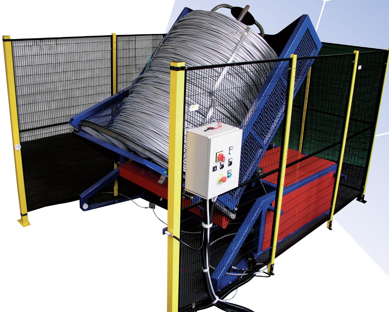
● Il **Ribaltatore RM 3000** è un apparecchio progettato per gestire, con **minimo sforzo, in tempi brevi e in tutta sicurezza**, un elevato numero di matasse pesanti fino a 3 tonnellate, le quali devono essere ribaltate dalla posizione orizzontale a quella verticale o viceversa.
