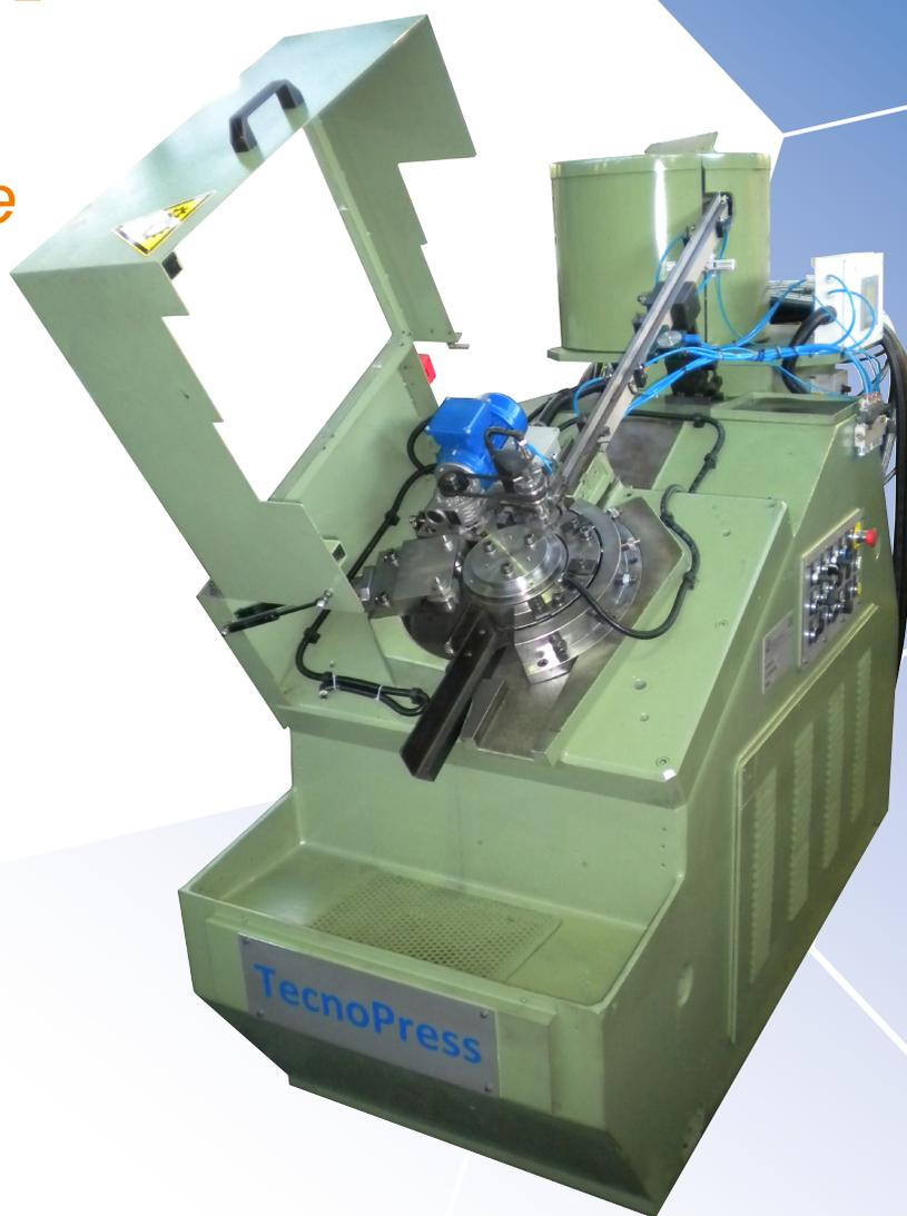
● La nostra nuova rullatrice TP2 GR TecnoPress, è una macchina totalmente innovativa che è stata concepita per la lavorazione a freddo di minuteria metallica stampata. Pur avendo la forma e la struttura di una classica filettatrice a rullo, non realizza filetti di tipo classico, ma è stata progettata al fine di realizzare rigature, zigrinature, gole e scanalature sulla superficie esterna.
