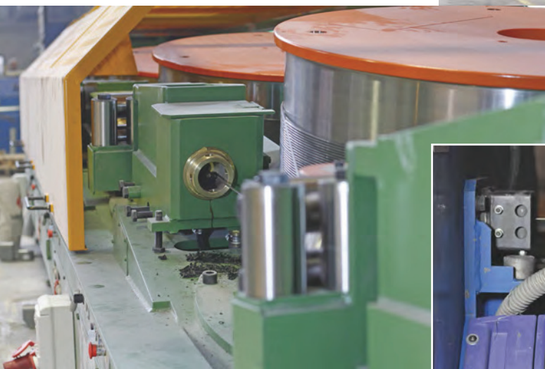
Trafilatrice con 5 passi e con cabestano da 1.200 mm di diametro.
