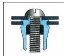
Avvitare finché il componente non è fisso. Screw until the component does not turn.
