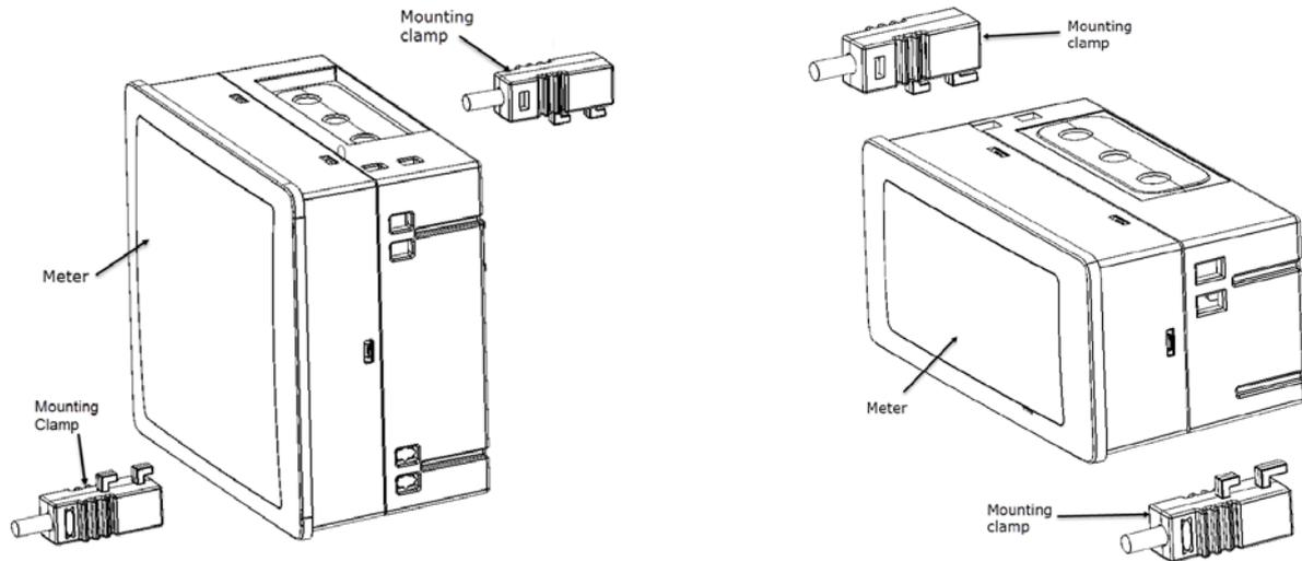
**Figure 1: Digital Panel Meter Parts**
