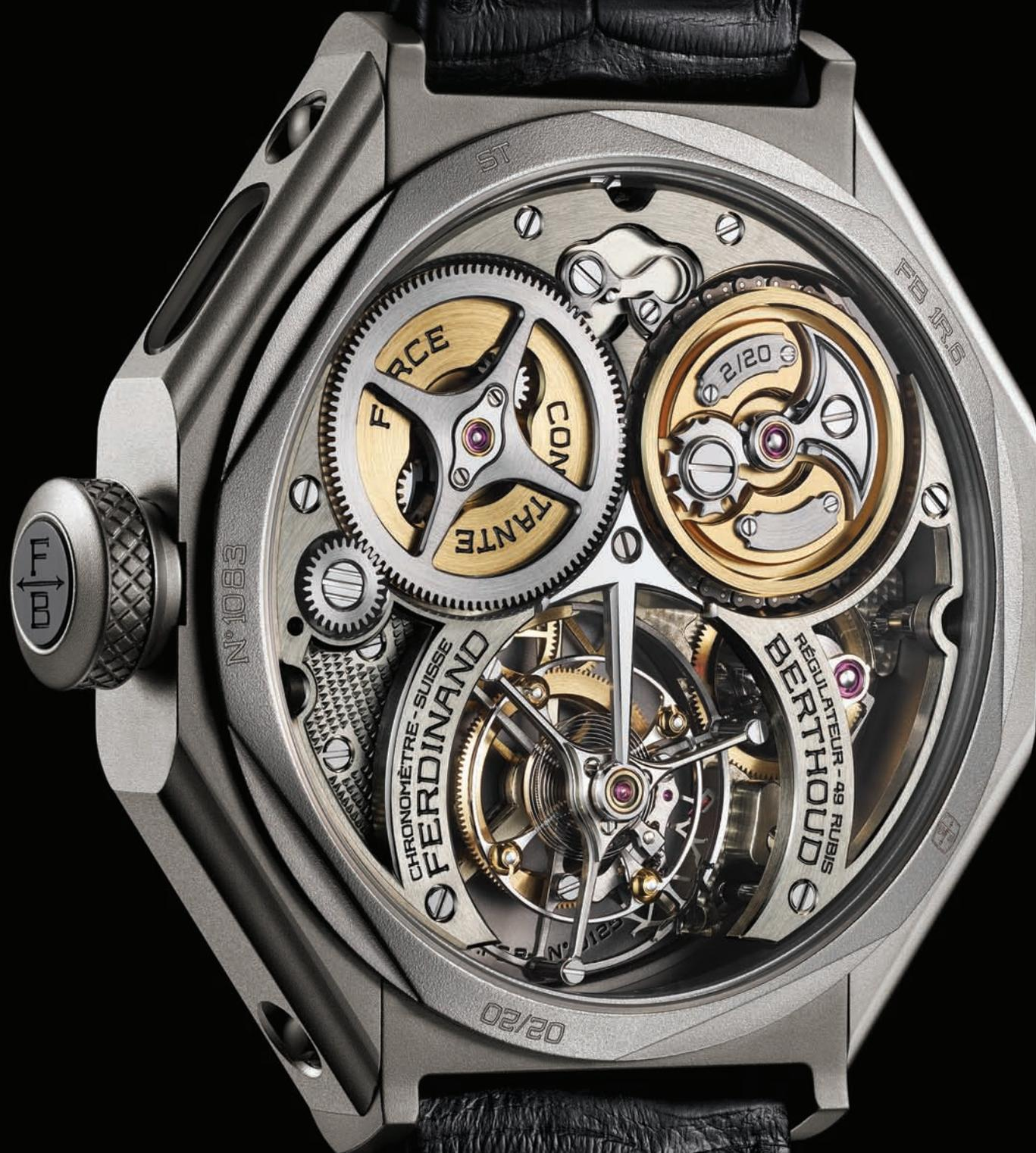
Особенностью калибра FB-T.F.C.R является необычное положение заводного барабана и фузеи: они перевернуты «с ног на голову» и находятся в подвешенном состоянии, будучи закреплены только с одной стороны. Эта конструкция, послужившая предметом заявки на патент, позволяет сэкономить несколько драгоценных миллиметров. Хронометр Ferdinand Berthoud FB 1R.6-1 диаметром 9,89 мм остается очень тонким для своей категории, несмотря на отдельную индикацию и новое устройство индикатора запаса хода.
