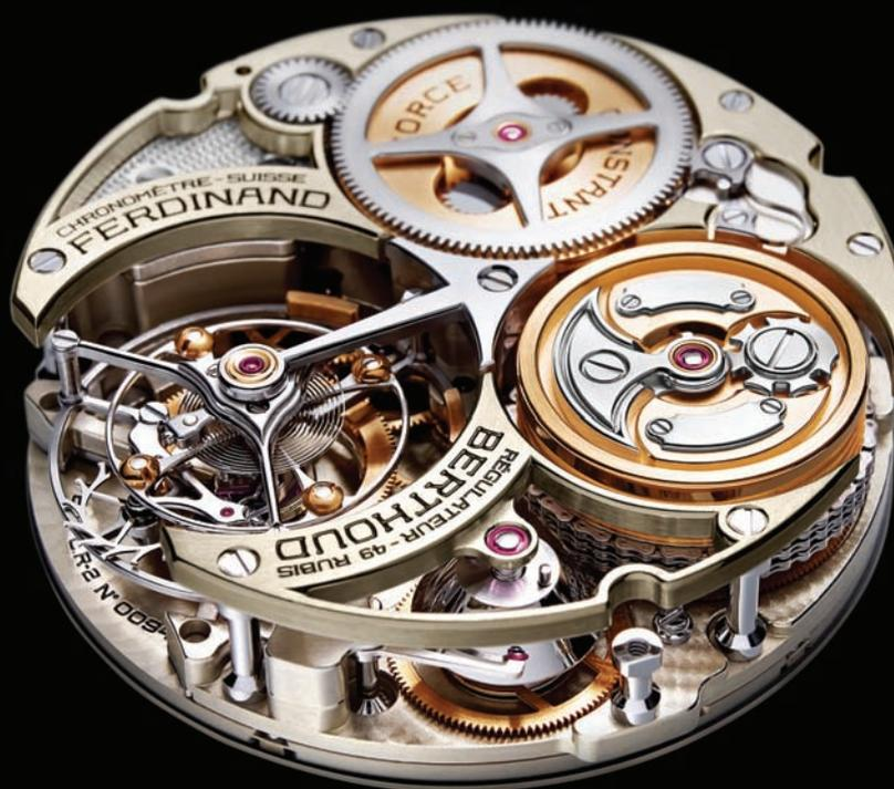
Калибр FB-T.FC.R с ручным заводом имеет уникальную структуру. Он насчитывает 18 мостов из мельхиора, которые заключены в пространство между колоннами из полированного титана, окружающими компоненты механизма. Именно такая конструкция была характерна для морских хронометров XVIII века. Она прослеживается в дизайне каждой детали часов и, главным образом, в симметрическом равновесии механизма.
