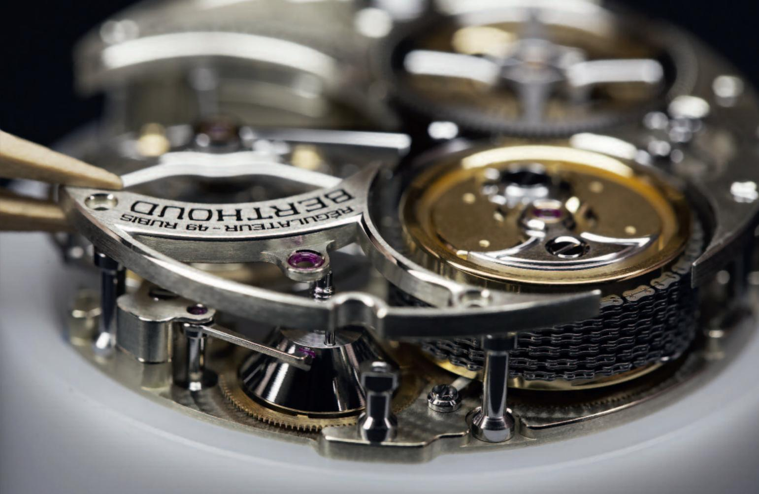
Uno sguardo al nudo movimento a carica manuale, calibro FB-T.F.C.R. In primo piano, due dei suoi punti di forza tecnico-estetici: la trasmissione fuso/catena e il tronco di cono parte integrante dell'innovativo sistema dell'indicazione di carica residua.
