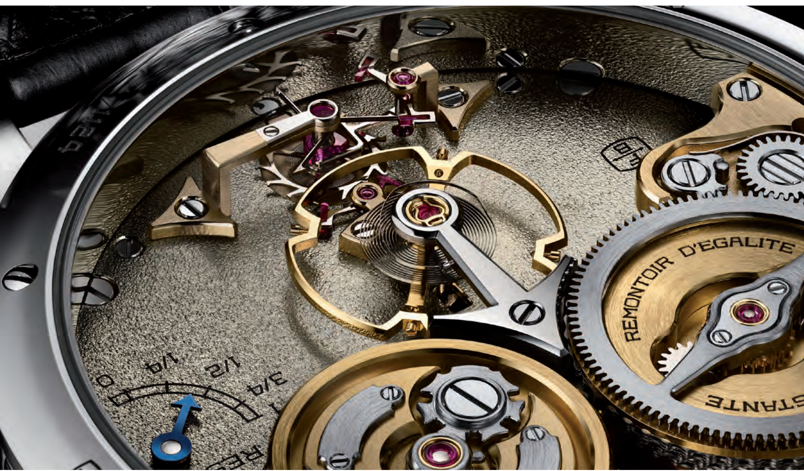
► Calibre FB-RE FC, movimiento de carga manual y fuerza constante, con transmisión mediante huso-cadena y "remontoir" de igualdad.
