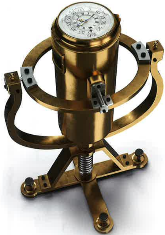
페르디낭드 베르투가 제작한 마린 크로노미터 No. 6. 1760년대 후반 코르벳함 리시스는 국왕의 명령으로 시계의 성능을 시험하기 위해 마린 클락 No. 6와 No. 8을 싣고 18개월의 항해를 무사히 마쳤다.
