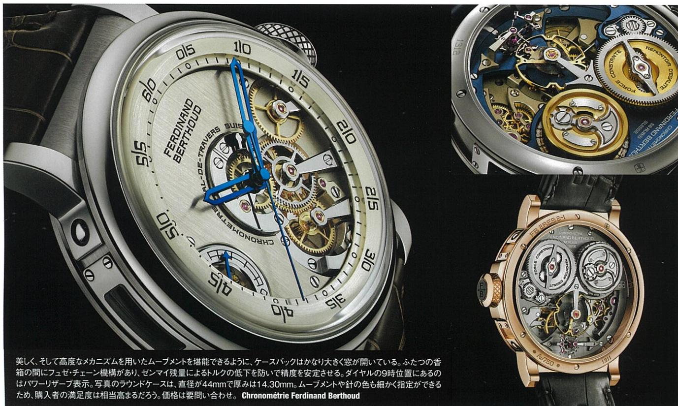
美しい、そして高度なメカニズムを用いたムーブメントを堪能できるように、ケースバックはかなり大きく窓が開いている。ふたつの香港の間にフュゼ・チェーン機構があり、ゼンマイ残量によるトルクの低下を防いで精度を安定させる。ダイヤルの9時位置にあるのはパワーリザーブ表示。写真のラウンドケースは、直径が44mmで厚みは14.30mm。ムーブメントや針の色も細かく指定ができるため、購入者の満足度は相当高まるだろう。価格は要問い合わせ。Chronométrie Ferdinand Berthoud
