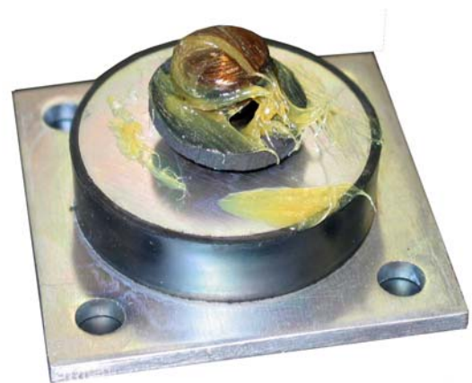
Abbildung 5: Bevor der Lastbolzen des Gummilagers in das Sackloch der Wägezelle eingeführt wird, ist der Lastbolzen mit Maschinenfett gut einzufetten.
