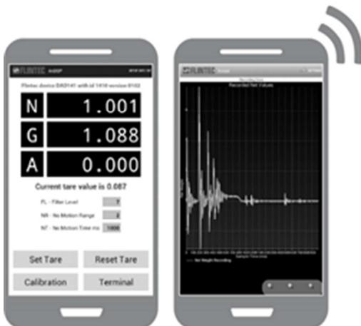
Die Drahtlose Anbindung des DAD 141.1 Wäge-Indikators wird über eine unabhängige WLAN-Verbindung realisiert.
