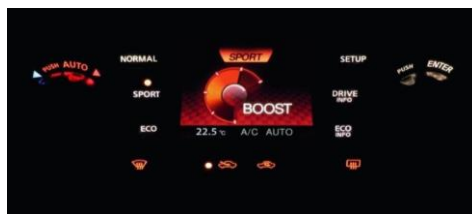
Nissan Dynamic Control System for kjøreinnstillinger og informasjon
