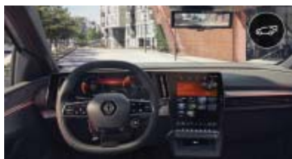
bakspeil med kamera (digitalt bakspeil). Overfører et bilde av området bak bilen til bakspeilet.
