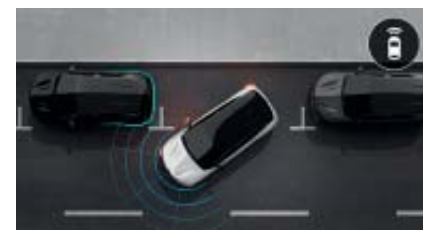
parkeringssensorer foran. Sensorene hjelper deg til å manøvrere bilen ved å gi hørbare og visuelle signaler om nærhet til hindringer foran deg.
