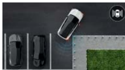
parkeringssensorer på sidene. Sensorene hjelper deg til å manøvrere bilen ved å gi hørbare og visuelle signaler om nærhet til hindringer.
