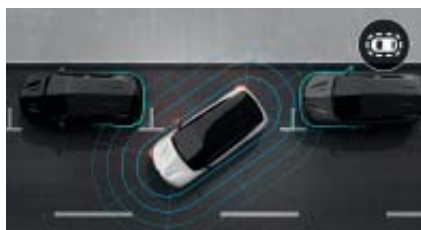
360-graders «3D-kamera». Fire kameraer plassert rundt bilen gir en 360-graders visning av området rundt, slik at du kan trygt manøvrere.
