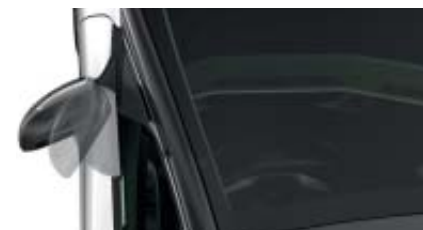
innfellbare speil med minne. Felles inn automatisk, vinkles ned ved rygging (passasjersiden) og husker bruksinnstillingen din.
