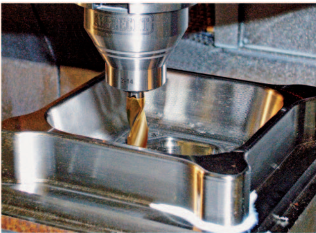
Schlank + kurz / Slim + short APC 14-S Ø 3 - 14 mm
