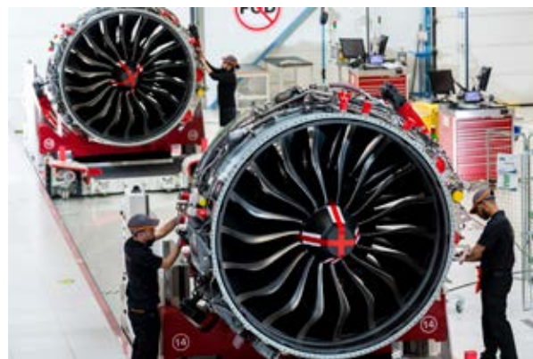
Safran - Installation de l'habillage moteur du LEAP-1A © P. Stroppa/Safran
