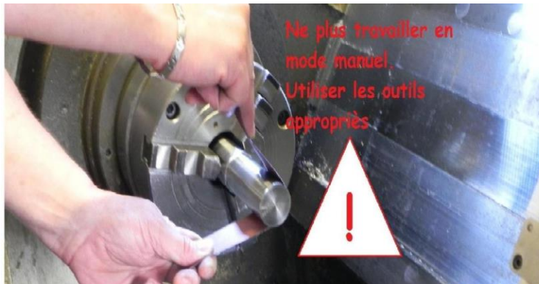
Figure 8 : Affiche de prévention sur les opérations de toilage (source : GC Innovation, soutien de la CARSAT et de l'UIMM)
