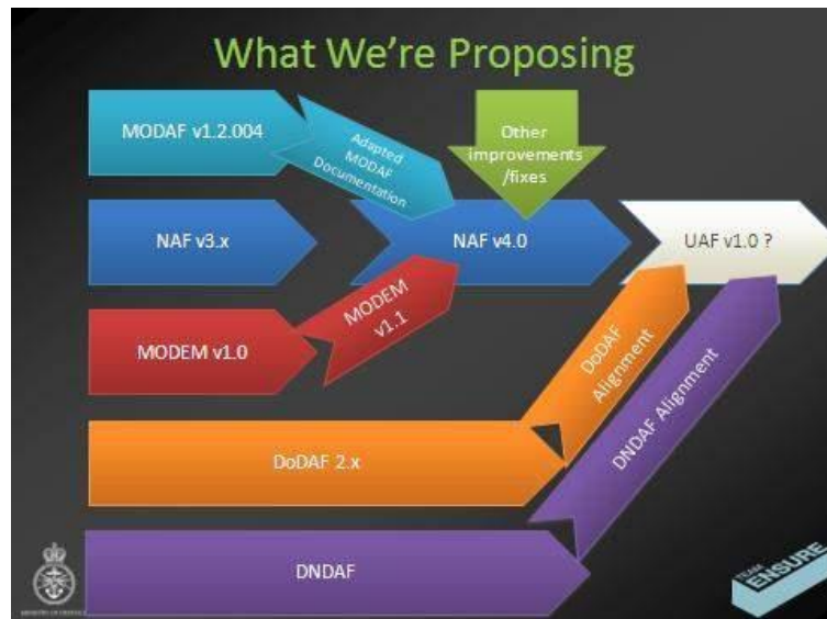
Schéma 4.19 : Convergence des cadres d'architecture (Présentation de Ian Bailey à la conférence OTAN SCO/IST Toulouse, mai 2013)
