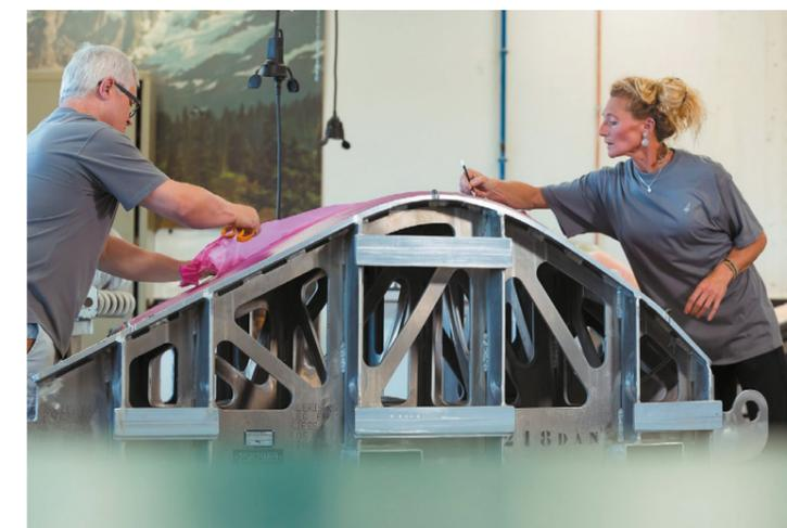
Dassault Aviation - Falcon 8X - Moulage RTM d'un winglet. Tissu d'arrachage avant peinture - © Dassault Aviation/A. Février
