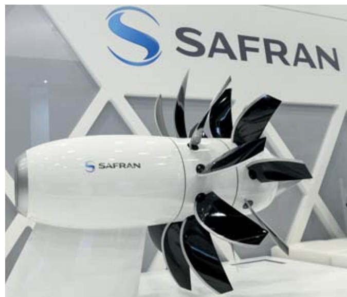
Safran - L'Open Rotor, architecture inédite de moteur d'avion, est conçu pour réduire la consommation de carburant et les rejets de CO 2 du transport aérien © GIFAS - G. Rolle
