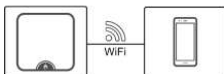
Afbeelding 7-1 De mobiele telefoon maakt rechtstreeks verbinding met de SUN2000L
