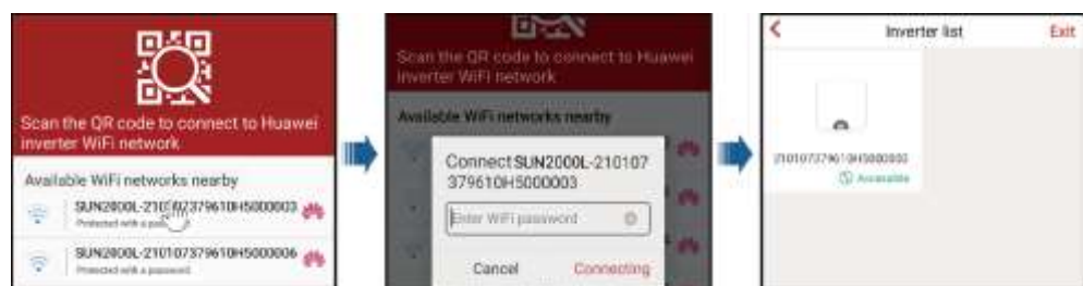
Afbeelding 7-5 De mobiele telefoon maakt rechtstreeks verbinding met de SUN2000L
