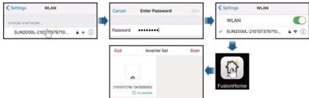
Afbeelding 7-8 De mobiele telefoon maakt rechtstreeks verbinding met de SUN2000L
