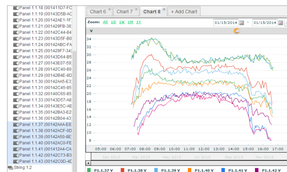
Er hoeft geen technicus het dak op: de spanning van het paneel wordt op afstand gemeten
