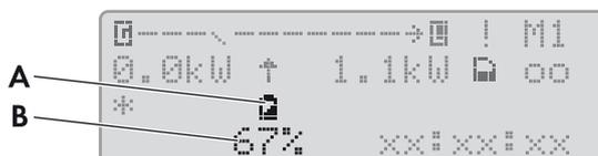
Figure 10 : État de charge de la batterie en mode standard (exemple)
