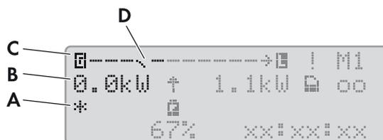
Figure 11 : État de la source d'énergie externe en mode standard (exemple)
