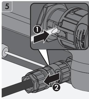
en Disassembling the DC Connectors de DC-Steckverbinder demontieren bg Демонтаж на DC свързвания щепсел cs Demontáž DC konektorů da Afmontering af AC-stikforbinder
