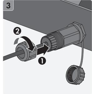
**en** Connecting RS485 Devices **de** RS485-Geräte anschließen **bg** Свързване на RS485 устройства
