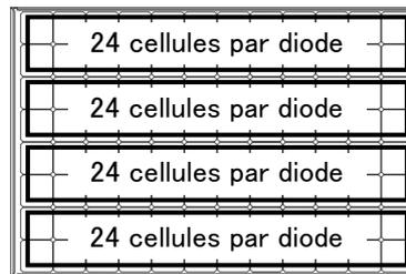
Figure 3. Nombre de cellules en série par diode by-pass
