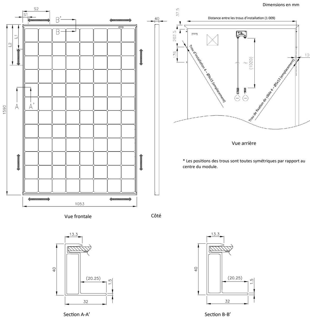
Remarque : un module est installé en utilisant 4 points et un montage symétrique dans les limites de fixation (zone hachurée). Les paramètres des limites de fixation sont indiqués dans le tableau intitulé « Emplacements de montage et résistance de charge ».
