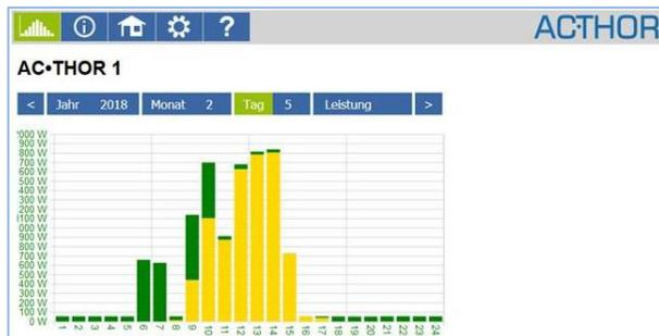
Les barres jaunes indiquent la proportion d'énergie provenant des cellules photovoltaïques, les barres vertes, la proportion de la sécurité de la température optionnelle.
