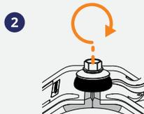
2. Serrez la vis jusqu'à ce que le joint EPDM du support entre en contact avec le joint en caoutchouc de la vis.
