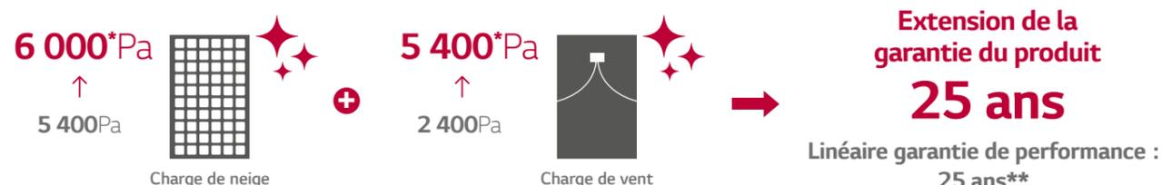
\* Les modules répondent aux exigences de la nouvelle version de la norme IEC 61215 : 2016 qui confirme 5 400Pa en face avant et 4 000Pa en face arrière. LG a réalisé des tests internes et confirme 6 000Pa/5 400Pa. \*\* 1) 1ère année : 98 %. 2) Après la 2ème année : 0,33 % dégradation annuelle. 3) 90,08 % après 25 ans.
