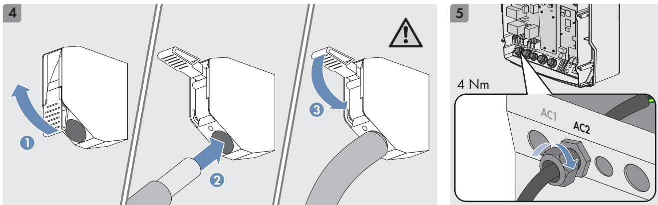
**en** Connecting the AC cable for the battery-backup system **de** AC-Kabel für Ersatzstromsystem anschließen
