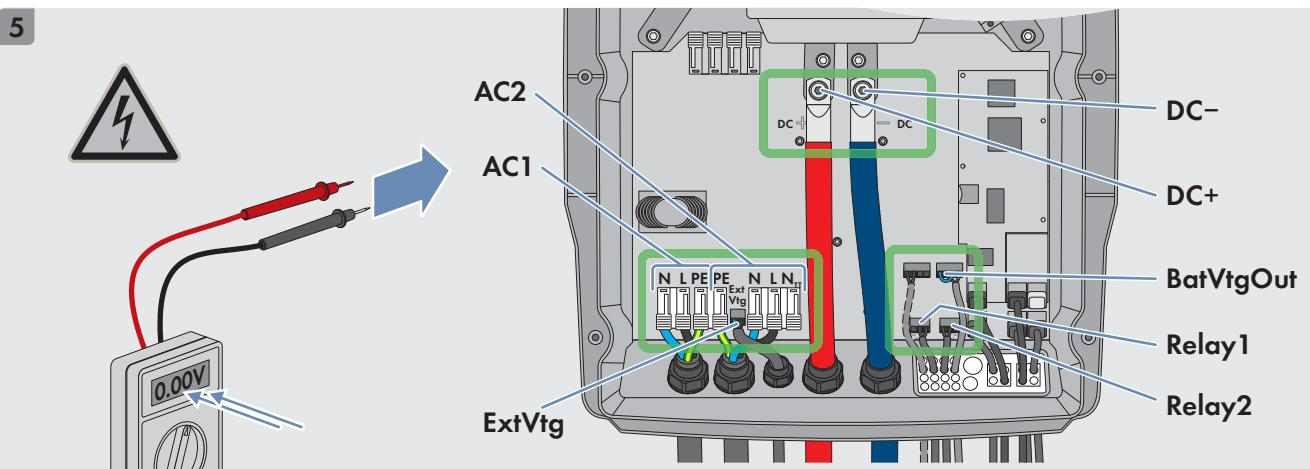
**en** Connecting the DC Power Cable **de** DC-Leistungskabel anschließen **bg** Свързване на кабел за постоянен ток
