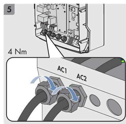
**en** Connecting the AC cable for the SMA Flexible Storage **de** AC-Kabel für SMA Flexible Storage anschließen
