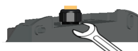
Fig. 6-15: Serrage du passe-câble à l'arrière
