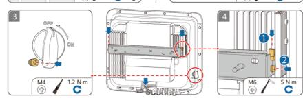
Preparing a PE Cable Vorbereiten des PE-Kabels 准备保护地线
