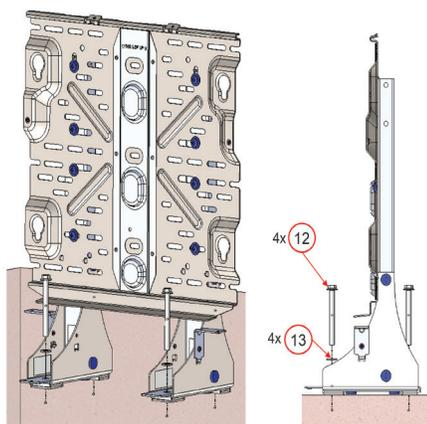
Montez l'unité de batterie sur le support de montage inférieur (sur la fente en trou de serrure) à l'aide des boulons de montage, et fixez les vis de blocage (couple de serrage de 5,6 N m) conformément au *Guide d'installation rapide de l'IQ Battery 5P*.
