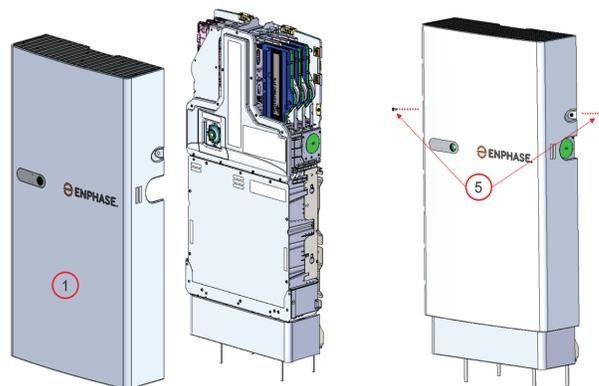
B. Utilisez des couvercles de conduits pour fermer les ouvertures de conduits non utilisées sur la batterie.
