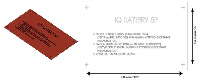
✓ **NOTE :** La surface de l'emplacement du forage doit avoir une épaisseur d'au moins 100 mm pour supporter l'installation au sol.
