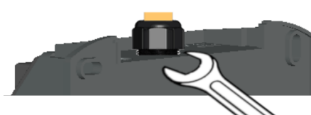
Afb. 6-15: Draai de kabelwartel aan de achterkant vast
