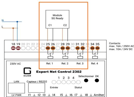
C) **Connexion au réseau** : Branchez le câble Ethernet provenant du routeur domestique ou du commutateur Ethernet sur le port LAN du SG Ready Relay, tel qu'indiqué sur la figure suivante :
