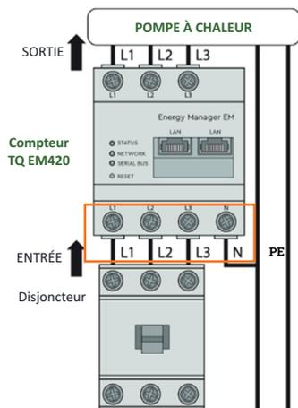
D) **Connexion au réseau** : Branchez le câble Ethernet CAT6 provenant du routeur domestique ou du commutateur Ethernet à l'un des ports LAN de l'Energy Meter, tel qu'indiqué sur la figure suivante :
