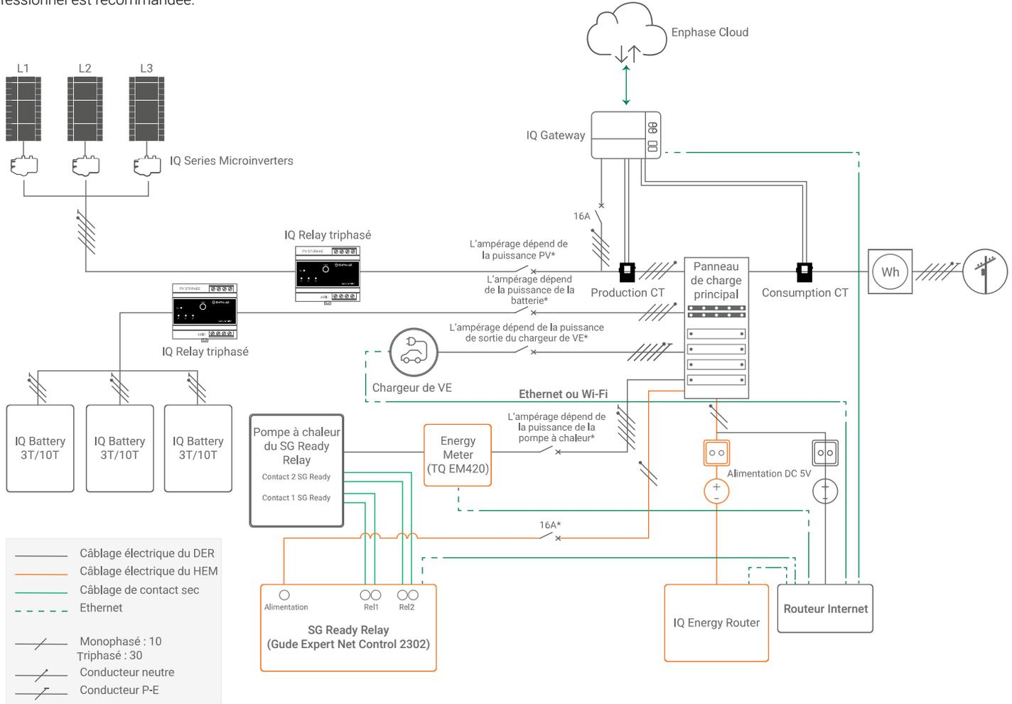
\*Tous les disjoncteurs représentés dans le schéma unifilaire peuvent être câblés à l'intérieur du panneau principal ou du sous-panneau
