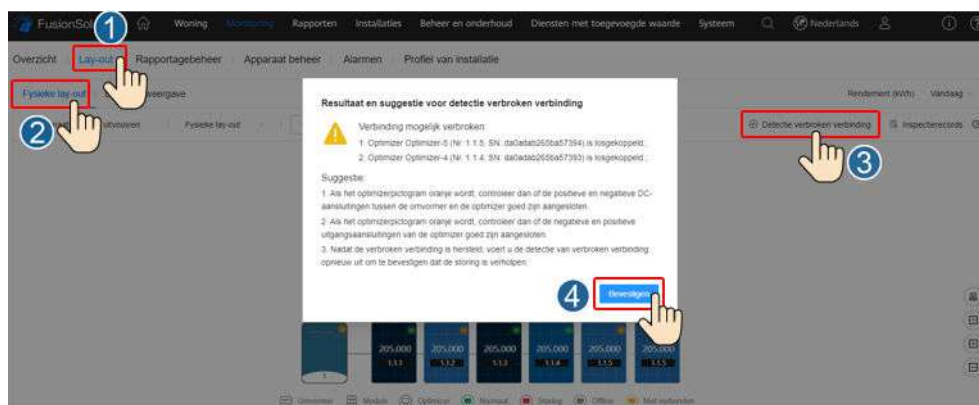
Afbeelding4-2 Detectie van verbroken verbinding met optimizer
