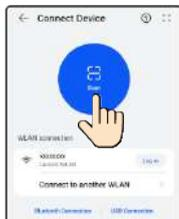
**EL** Συνδεθείτε στην εφαρμογή FusionSolar ως υπεύθυνος εγκατάστασης, επιλέξτε **Services** > **Commission Device** και συνδεθείτε στο σημείο πρόσβασης WLAN του αντιστροφέα.
