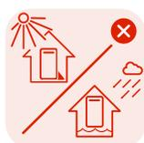
Respectez les normes locales : Choisissez un emplacement bien aéré où la température ambiante et l'humidité sont comprises dans les plages suivantes :  $-20^{\circ}\text{C}$  à  $55^{\circ}\text{C}$  et 5% à 95% d'humidité relative, sans condensation, non exposé à la lumière directe du soleil. La plage de température ambiante optimale de l'emplacement d'installation est comprise entre  $0^{\circ}\text{C}$  et  $30^{\circ}\text{C}$ .
