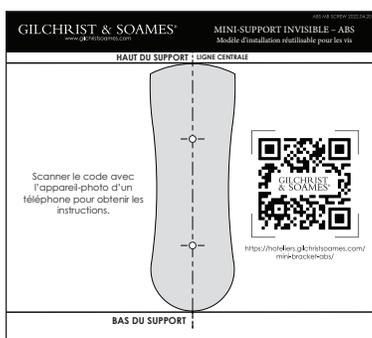
Les lignes centrales et le bord supérieur des supports sont illustrés pour aligner les supports horizontalement sur le mur.
