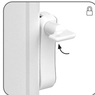
Verrouiller le support en insérant la clé et en la tournant de 90° dans le sens HORAIRE.
