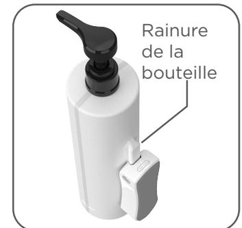
Aligner la rainure à l'arrière de la bouteille avec la fente du support.
