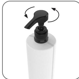
Ouvrir la pompe de la bouteille en tournant le bec dans le sens ANTIHORAIRE jusqu'à ce qu'elle se soulève.
