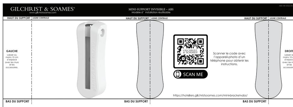
Les lignes centrales et le bord supérieur des supports sont illustrés pour aligner les supports horizontalement sur le mur.
