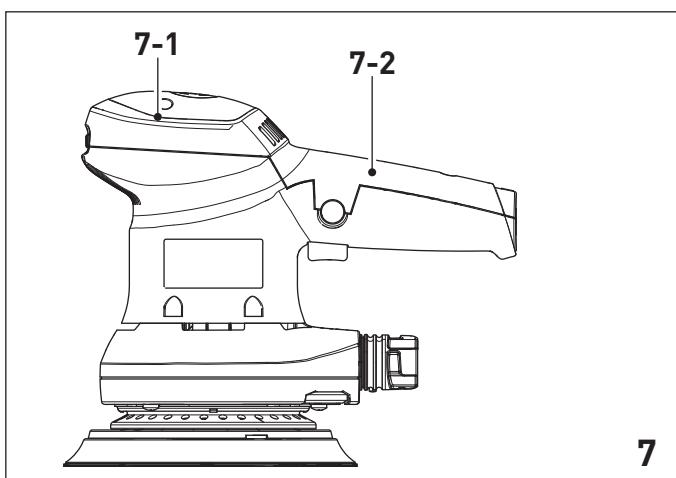
Pour un guidage fiable, tenir la machine avec les deux mains sur le carter du moteur [7-2] et sur la tête d'engrenage [7-1].
