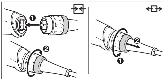
Voir la connexion et la déconnexion du câble de raccordement secteur sur la figure ci-contre. L'interrupteur [2-1] sert d'interrupteur de marche/arrêt. Pour un fonctionnement en continu, vous pouvez le bloquer avec le bouton d'arrêt [2-2] latéral. Appuyez à nouveau sur l'interrupteur pour libérer le blocage.
