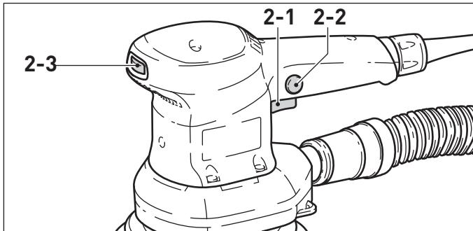
El interruptor **[2-1]** se emplea como interruptor de conexión/desconexión. Para un servicio continuo, éste se puede bloquear mediante el botón de bloqueo lateral **[2-2]**. Pulsando de nuevo el interruptor éste se desbloquea.
