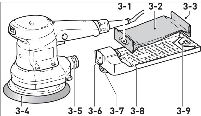
Lorsque le filtre turbo est rempli de poussières, la performance d'aspiration baisse et il faut le remplacer:
